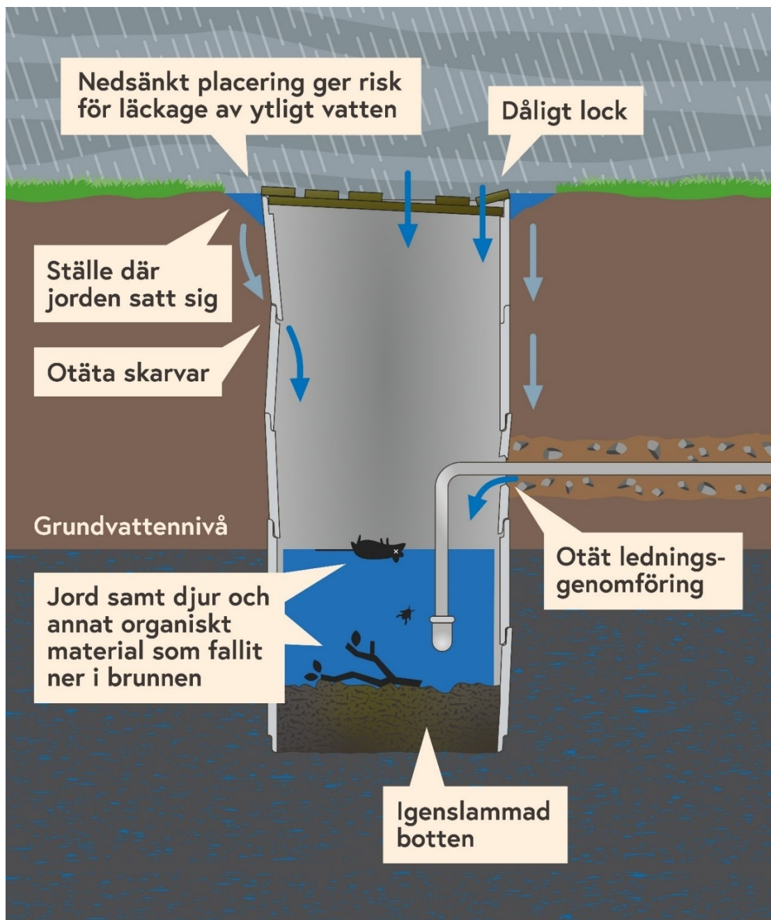
Figur 17. Kritiska punkter i grävda brunnar. De blå pilarna illustrerar ställen där ytligt vatten kan tränga in och förorena brunnen.
